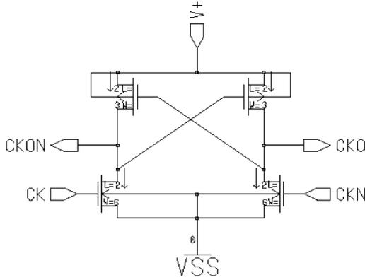
Fig. 11. Clock level shifter
