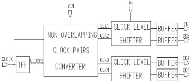
Fig. 8. Clock pairs generator
